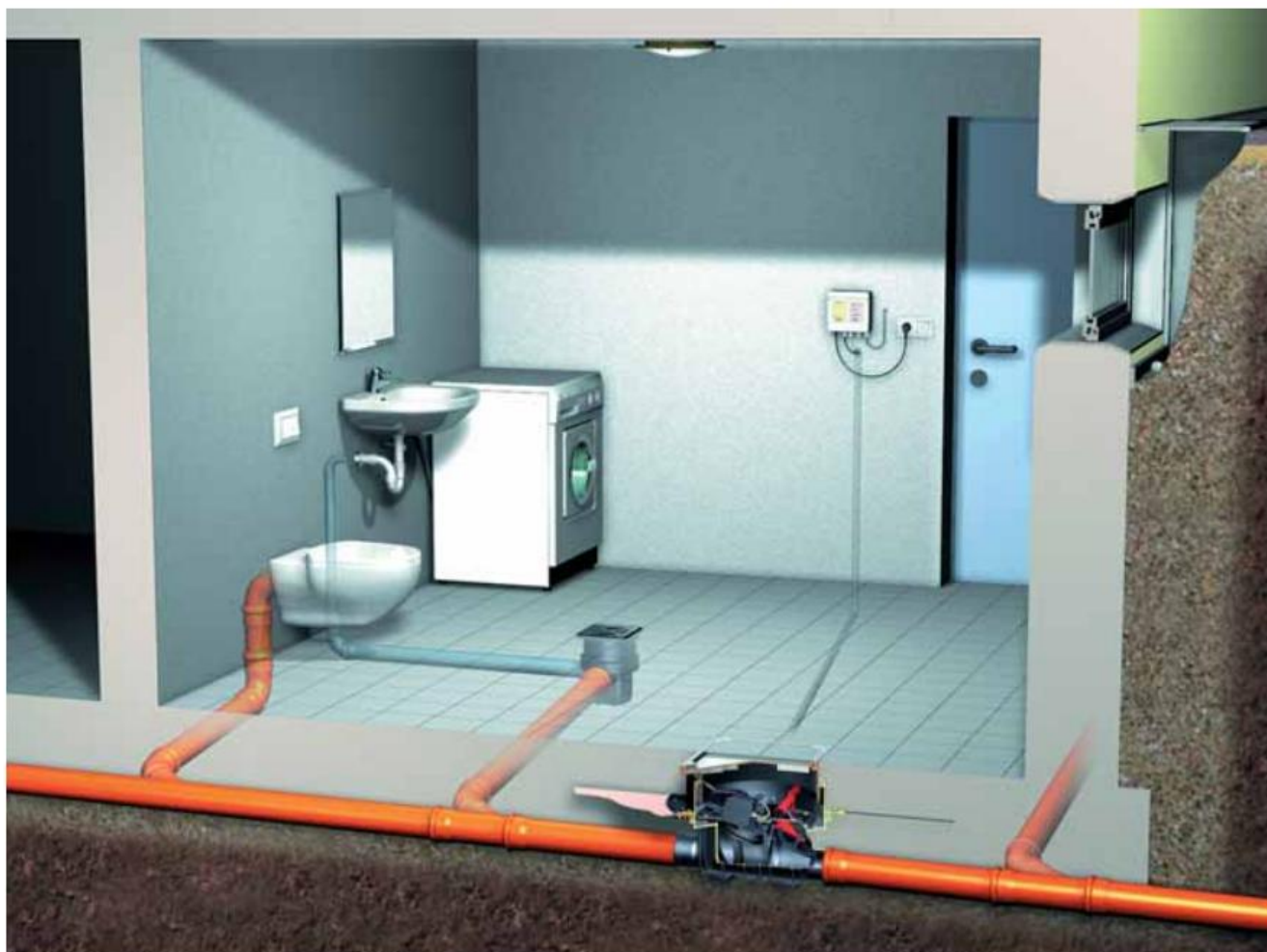
Zabezpieczenie miejsc odpływu poniżej poziomu zalewania za pomocą automatycznego zaworu przeciwwzalewowego Staufix FKA.
