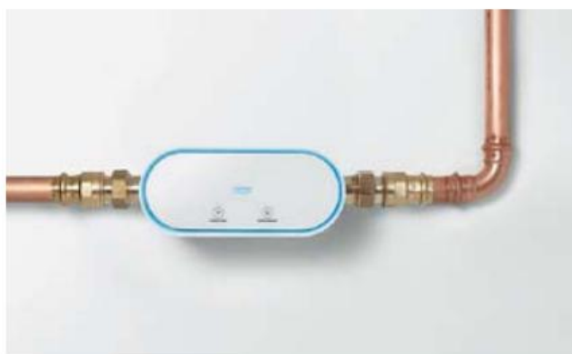
Sense Guard marki Grohe śledzi zużycie wody i wykrywa małe przecieki, a w przypadku pękniętej rury automatycznie odcina dopływ wody. Dodatkowo, w przypadku wykrycia wycieku wody, Sense Guard natychmiast wysyła powiadomienie za pomocą aplikacji Grohe Ondus, niezależnie od tego, czy jest to mały przeciek czy pęknięta rura.
